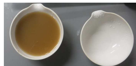
写真-3 56分後の排水水 左：ケース1 右：ケース2
