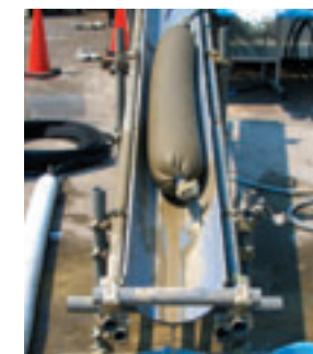
● パッカー内面のパイル糸がグランドの編目からグラウト漏出と共に押出され、編目を目詰まりさせます。
